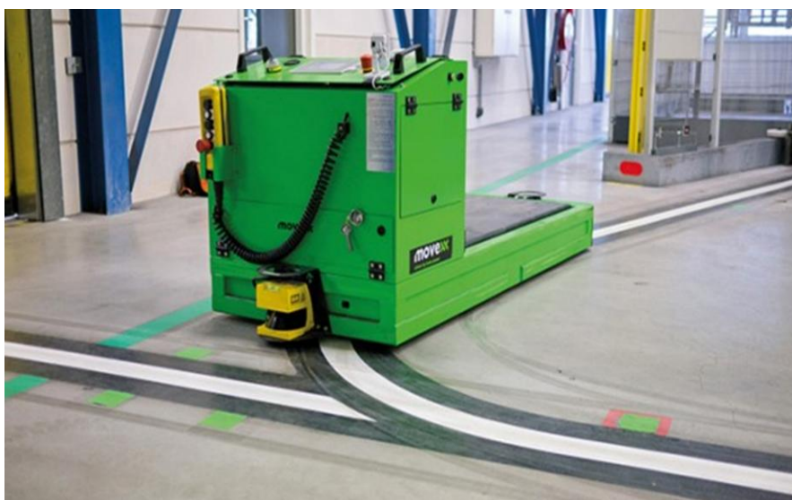
Automaticky riadené vozidlo, ktoré sa používa na prepravu tovaru v rámci výrobného závodu alebo skladu, nasleduje označenú cestu na podlahe
