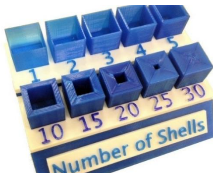
Obr. 55 Ukážka počtu stien 3D tlačéných objektov bez výplne https://3dgadgets.com.my/fdm-3d-printing-guide/
